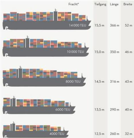
\* 1 TEU (Twenty-foot Equivalent Unit) = 1 Container (Länge: 20 Fuß, Breite: 8 Fuß, Höhe: 8 1/2 Fuß entspricht: Länge: 6,058 m, Breite: 2,438 m, Höhe: 2,591 m)
